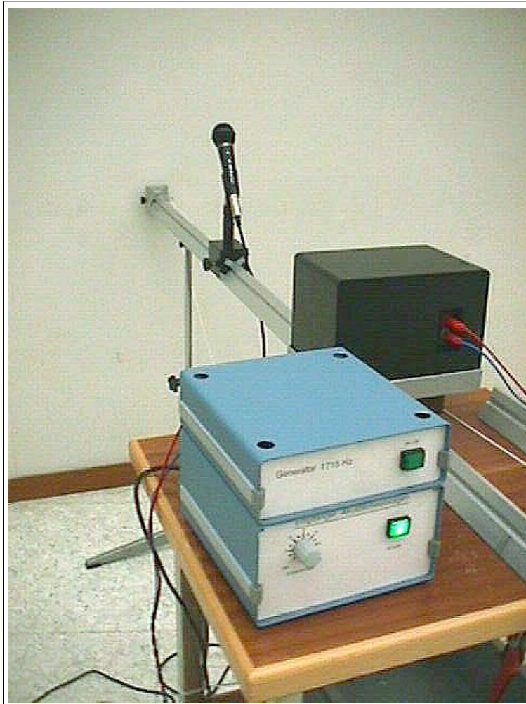
Abbildung 1: Versuchsanordnung „Stehende Schallwellen“
